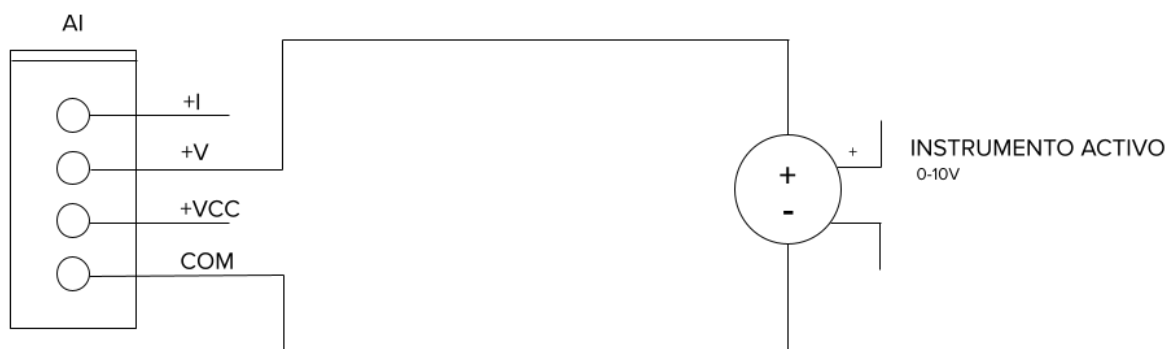
Figura 16 - Conexión de instrumentos activos para medición de tensión.
