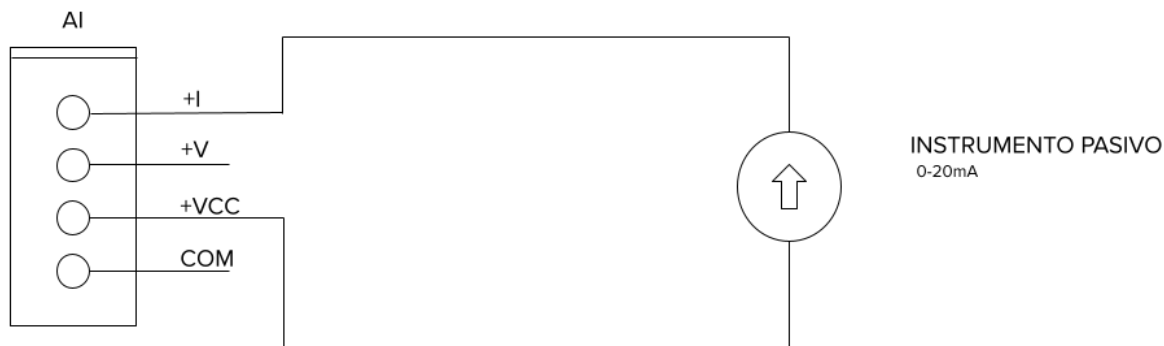
Figura 15 - Conexión de instrumentos pasivos para medición de corriente.
